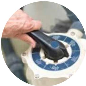
Tournez le réglage du filtre de « Filtration » à « Recirculation » pendant 20 secondes. Cela permet à l'eau dans le filtre de se déposer.
