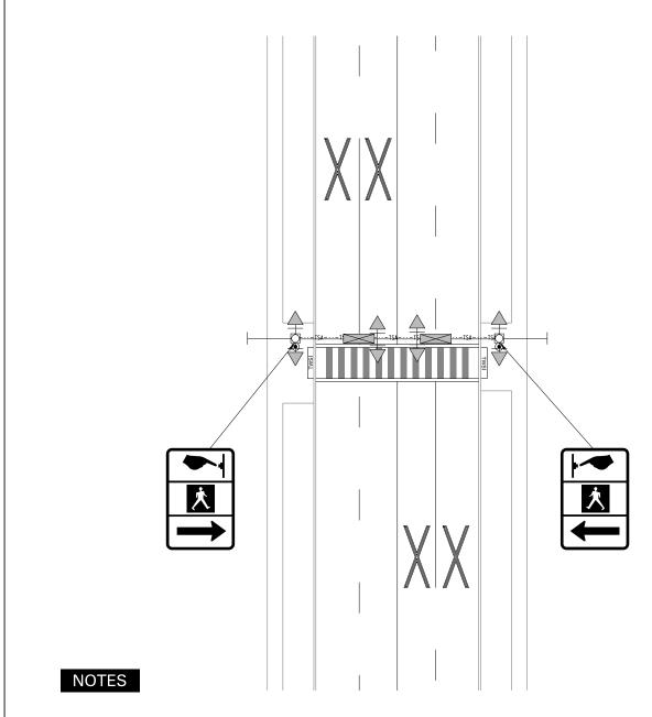
1. LEVEL 1 TYPE A PEDESTRIAN CROSSOVER ARRANGEMENT SHOWN FOR REFERENCE ONLY. PUSHBUTTON INFORMATION SIGNS APPLICABLE TO LEVEL 1 TYPE A AND LEVEL 2 TYPE B PEDESTRIAN CROSSOVER ARRANGEMENTS.
